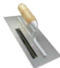
Ideales para trabajos de afinado en superficies (extender y alisar masillas o mezclas gruesas y finas) nos permite realizar un excelente acabado en diferentes texturas.
